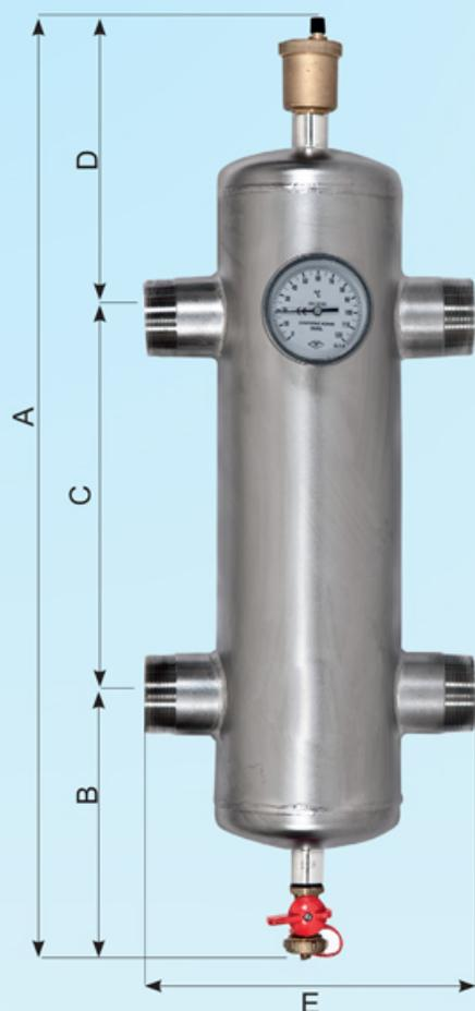
Il **Separatore Idraulico Multifunzionale SRG**, è un dispositivo che, negli impianti di riscaldamento e raffrescamento, svolge la funzione di rendere indipendenti i circuiti primari e secondari collegati tra loro, compensando le differenze di portata che attraversano i circuiti.
